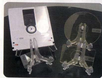
Образцы голографических носителей, изготовленные компанией InPhase Technologies
