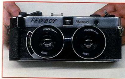
Стереокамера, созданная в 1988 году на базе «Фэд-Микрон-2», давала 21 стереопару, по 2 кадра в каждой паре (1 кадр — 24×30 мм) на стандартной 35-мм пленке. Стереобаза — 63,4 мм. Снабжалась двумя объективами «Индустар-81» 2,8/38 с пределами фокусировки от 1 м до бесконечности
